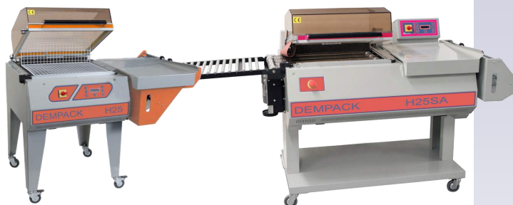
DEMPACK H25 / H25 SA Cadre de soudure de 560 x 430 mm
