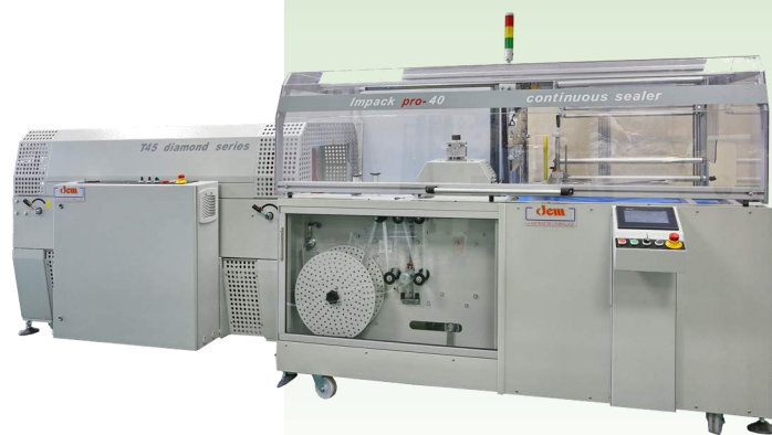
IMPACK 40 PRO associée à un tunnel de rétraction T45
