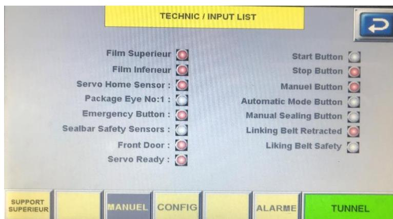
Quand vous devez vérifier les signaux entrants vers la machine telle que les capteurs, les signaux de déclenchement peuvent être contrôlés ici.
