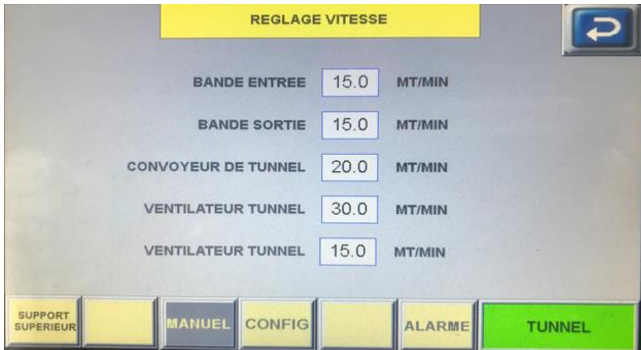
Les vitesses peuvent être modifiées en cliquant sur les chiffres de la vitesse réelle. Ensuite, un clavier numérique sera ouvert. Entrez les nouveaux paramètres et fermez le pavé numérique. Le paramètre sera enregistré dans la mémoire du système automate.
