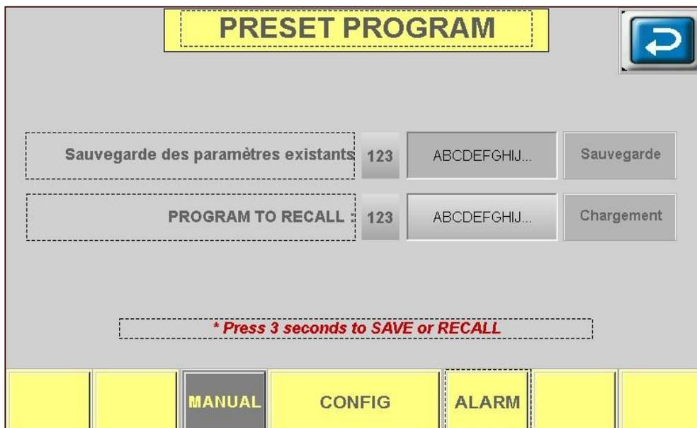
Les paramètres des réglages peuvent être sauvegardés ou rappelés par le système de mémoire des données.
