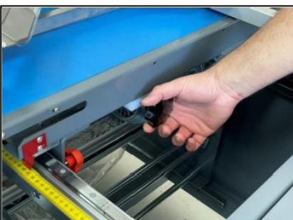
Retirez une grande quantité de film pour les enfiler confortablement. Ensuite, déverrouillez le triangle et la bande transporteuse pour faciliter l'application du filetage. Le bouton rouge déplace la bande transporteuse et le bouton noir sépare et déplace l'ensemble triangulaire de la bande transporteuse.
