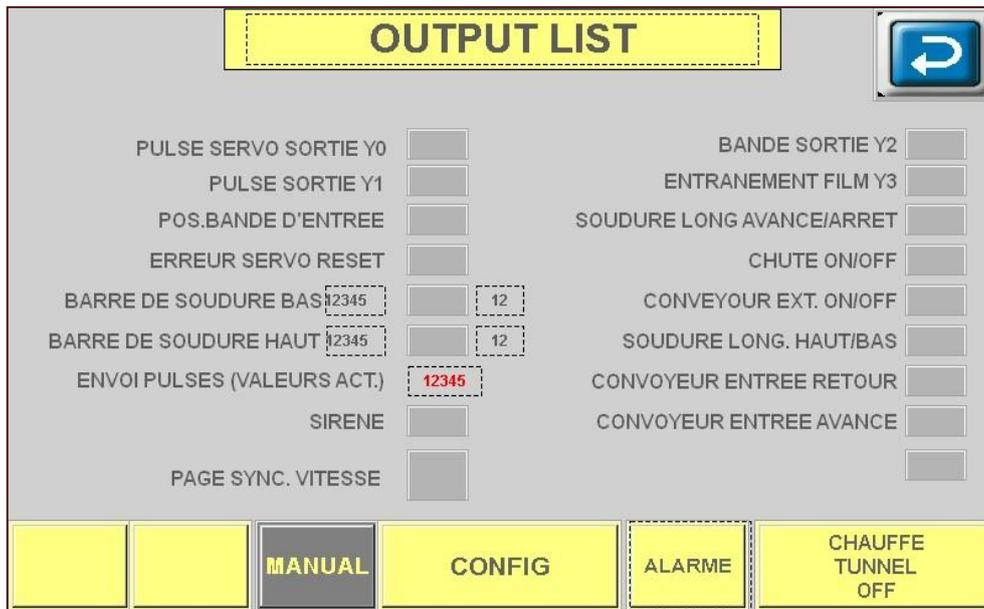
**PULSE SERVO SORTIE Y0:** Lorsque l'automate envoie une commande à la barre de soudure, ce bouton se déplace vers le haut / bas.
