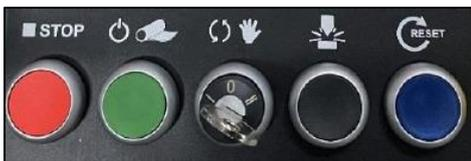
**Mode Automatique :** fait fonctionner toutes les bandes transporteuses, la soudure transversale et la soudure longitudinale. Appuyez sur le bouton de démarrage vert pour fonctionner en mode automatique.
