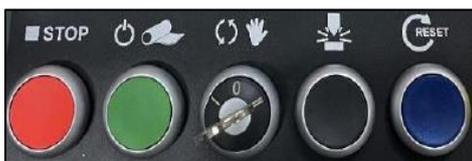
**Mode manuel :** fait fonctionner toutes les bandes transporteuses, la soudure transversale et la soudure longitudinale uniquement lorsque vous maintenez enfoncé le bouton de démarrage vert. Les radiateurs chauffent toujours. Ce mode est particulièrement utile lors de l'enfilage du film.
