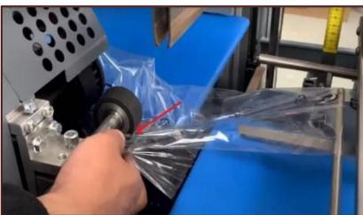
En assemblant les deux couches de film ensemble, faites passer le film à travers ces deux supports comme indiqué à gauche.
