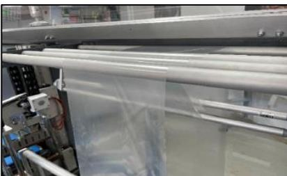
Le film doit être enfilé à travers les équilibreurs. Suivez le chemin indiqué sur le schéma d'enfilage du film. Verrouillez les arbres de transmission et comblez l'espace entre eux. Mettez la machine en mode MANUEL pour pouvoir retirer le film lors de son enfilage dans les équilibreurs.
