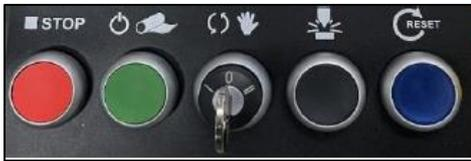
**Mode Arrêt :** arrête les bandes transporteuses, la soudure transversale et la soudure longitudinale. Les radiateurs chauffent toujours mais toutes les fonctions mobiles sont en mode Stop.
