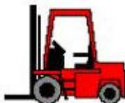
Assurez-vous que le chariot élévateur tient la machine par le châssis principal pour éviter tous dommages potentiels et qu'aucun organe mécanique ou câble électrique ne restent bloqués entre les fourches du chariot et le châssis de la machine.
