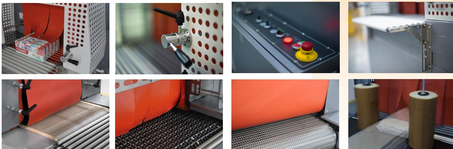
La gamme des tunnels Mini / Midi est facilement intégrable sur une chaîne de production, aussi bien aux lignes semi-automatiques qu'automatiques. Ce tunnel de rétraction à chauffage par air pulsé fonctionne sur le principe du recyclage permanent de l'air chaud.
