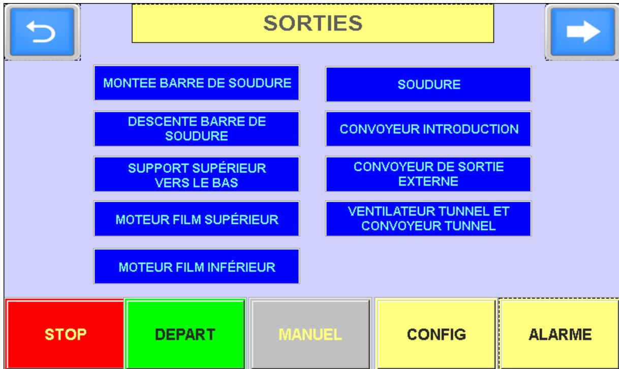
**MONTEE BARRE DE SOUDURE** : déplace manuellement la barre de soudure vers le haut.
