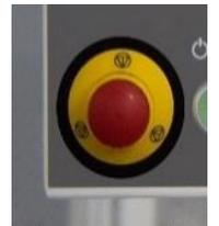
Pendant ce temps, pendant que le bouton d'arrêt d'urgence est enfoncé, un message d'alarme sera actif sur le panneau de commande indiquant l'état. Veuillez consulter la section Alarmes pour plus de détails.
