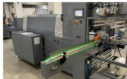
**CONVOYEUR DE SORTIE EXTERNE** : est le convoyeur à la fin de la ligne sur lequel est monté le ventilateur de refroidissement. Cette touche fait fonctionner manuellement le convoyeur de sortie externe.
