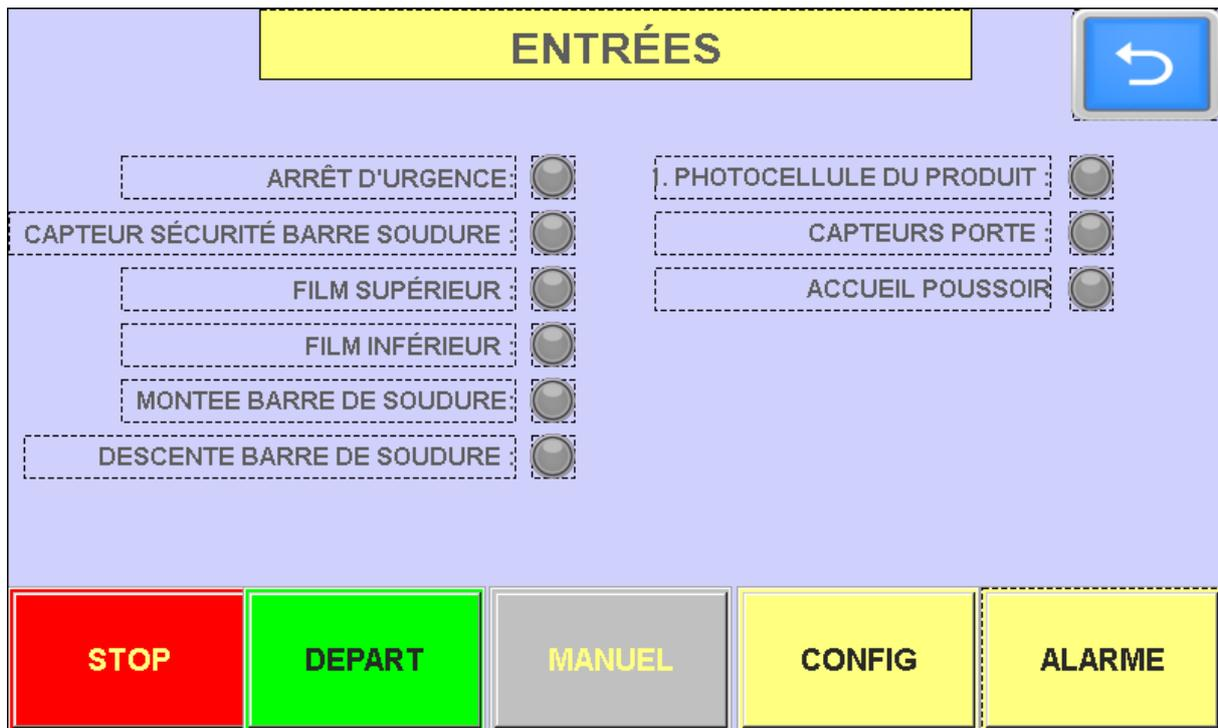
Quand vous devez vérifier les signaux entrants vers la machine telle que les capteurs, les signaux peuvent être contrôlés ici.
