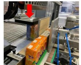
**MOTEUR FILM SUPÉRIEUR** : fait tourner les arbres d'entraînement du moteur du film supérieur vers l'avant.
