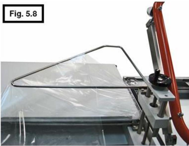
18. Introduisez le rouleau réglable dans un ensemble d'encoches qui aligne le film sur la hauteur de la lame de l'onduleur supérieure. Lorsque le film quitte le rouleau réglable, les couches supérieure et inférieure doivent diverger de manière égale pour atteindre les deux charrues à retournement.
