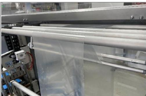
5- Le film doit être enfilé dans les équilibres. Suivez le chemin indiqué sur le schéma d'enfilage du film.
