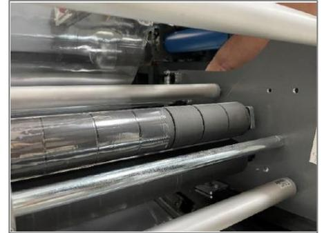
L'arbre d'entraînement inférieur a une position fixe et est relié au moteur d'entraînement. L'arbre supérieur peut se déplacer vers le haut à l'aide de la poignée située sur la paroi extérieure du tiroir à film. En déplaçant l'arbre supérieur vers le haut, un espace entre les arbres permet d'enfiler facilement le film.
