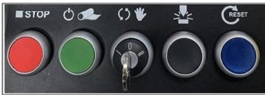
**Mode Arrêt :** arrête les bandes transporteuses, la soudeuse transversale et la soudeuse latérale. Les éléments chauffants sont toujours chauffés mais toutes les fonctions de déplacement sont en mode Arrêt.
