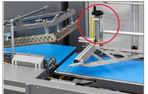
Le rouleau illustré sur les images de droite permet au film plié de s'écouler depuis le centre du triangle supérieur et inférieur. Après avoir réglé la hauteur du triangle, n'oubliez pas de repositionner le rouleau de support du film en fonction du point central des triangles.
